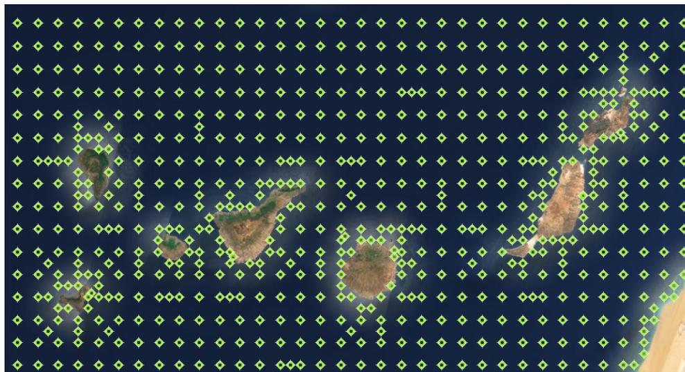
Figura 4. Ejemplos de densidad espacial de los nodos SIMAR en el Mediterráneo (arriba) e Islas Canarias (abajo).
