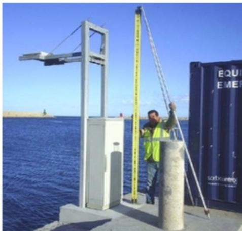
Figura1. Sensor radar MIROS en el Puerto de Gandía (izquierda) y esquema de instalación de mareógrafo acústico (derecha).
