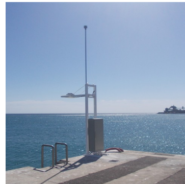
Fig. 2. Mareógrafos REDMAR con estación meteorológica instalada
