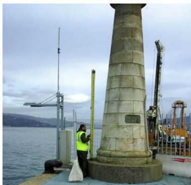
Fig. 2. Mareógrafos REDMAR con estación meteorológica instalada
